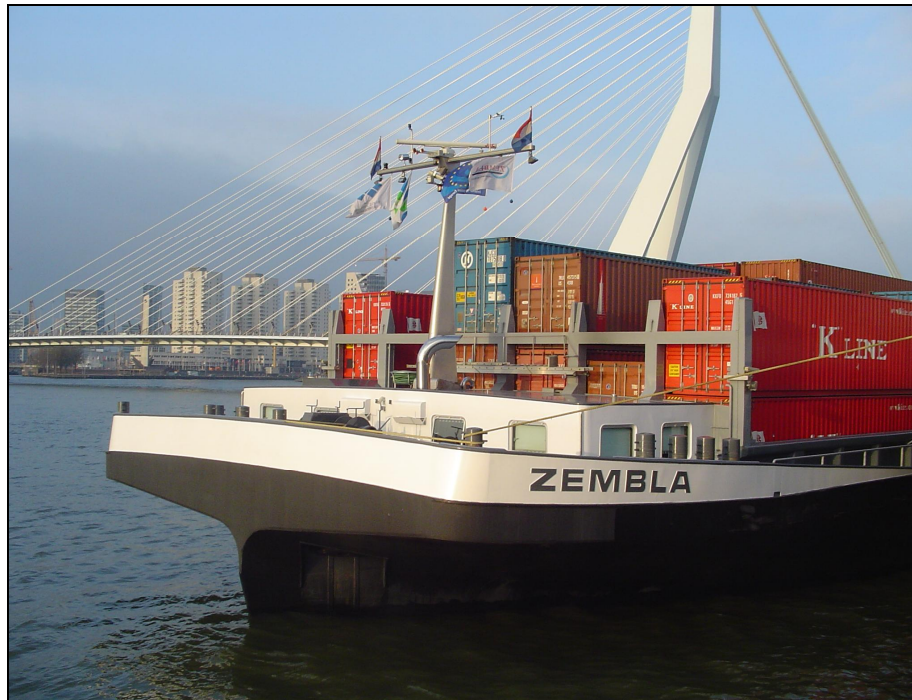
Verschillen in ladinghoogte door de aanwezigheid van high-cube containers
