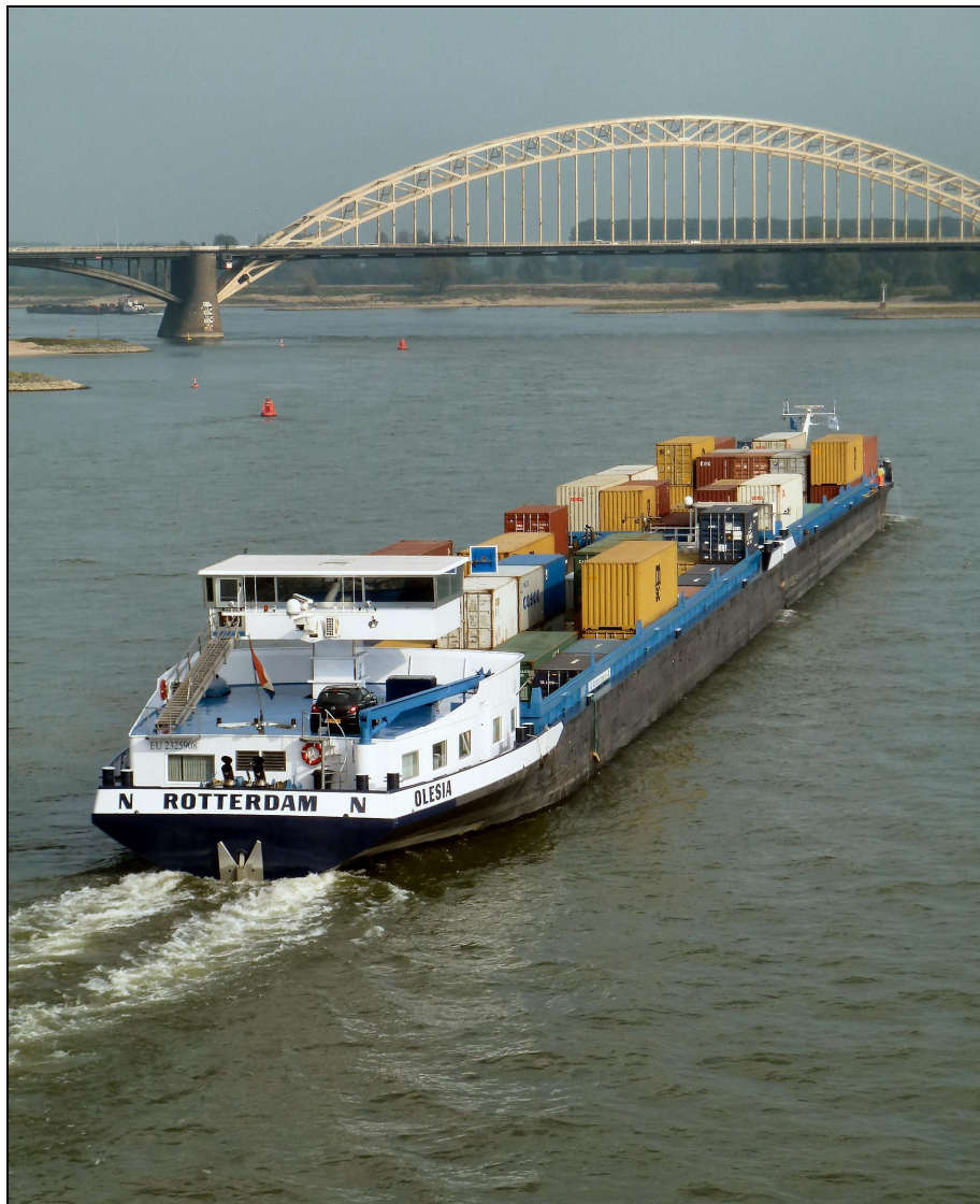
Koppelverband klasse VI op de Waal bij Nijmegen, maximale capaciteit 538 TEU
